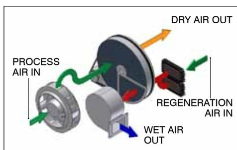
Der Silica Gel Rotor führt einen Teil der Luft durch das Regenerationssegment wobei die Luft stark erhitzt wird und die heiße, feuchte Luft dann per Schlauch nach draußen geführt wird.
